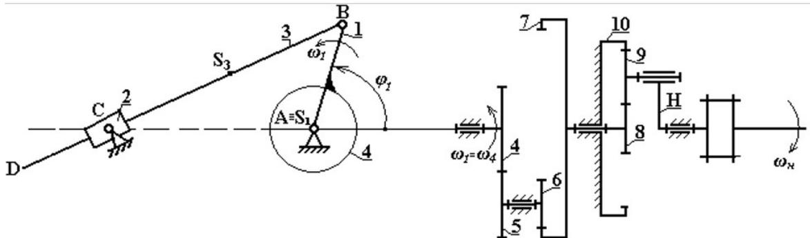
1. Для планетарной ступени зубчатого механизма определить степень подвижности.
