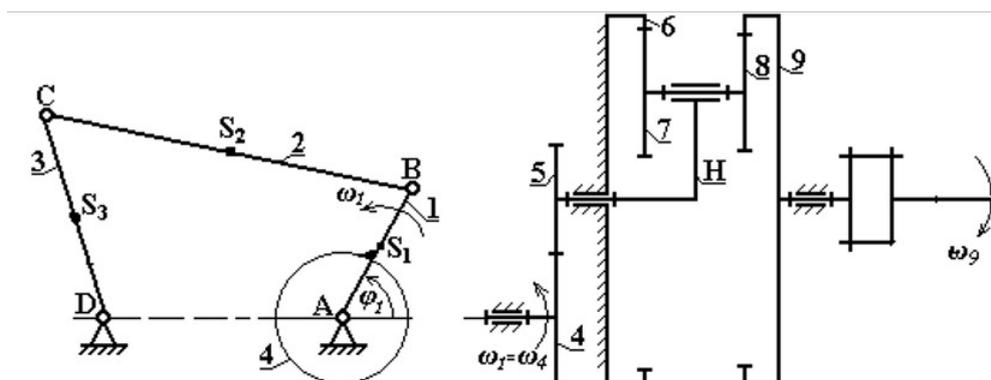
1. Для планетарной ступени зубчатого механизма определить степень подвижности.
