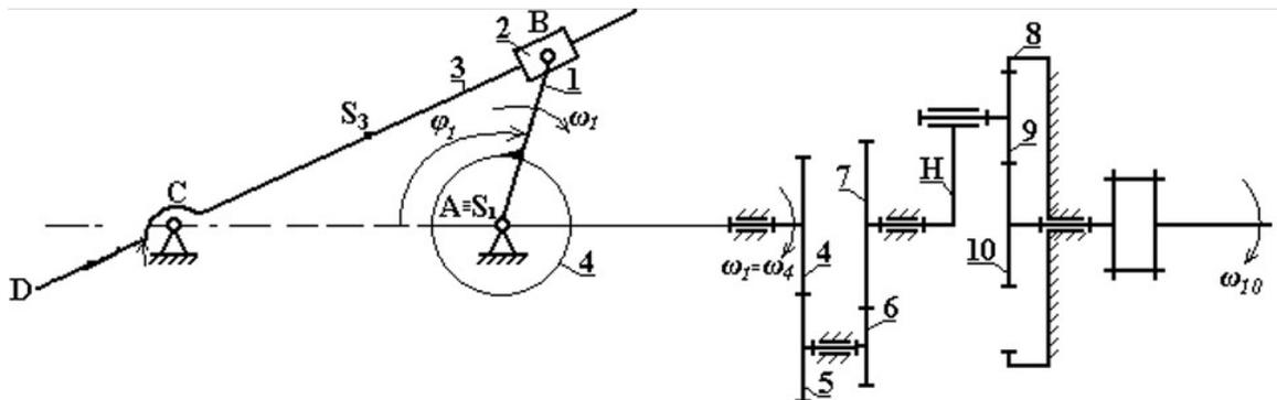
1. Для планетарной ступени зубчатого механизма определить степень подвижности.
