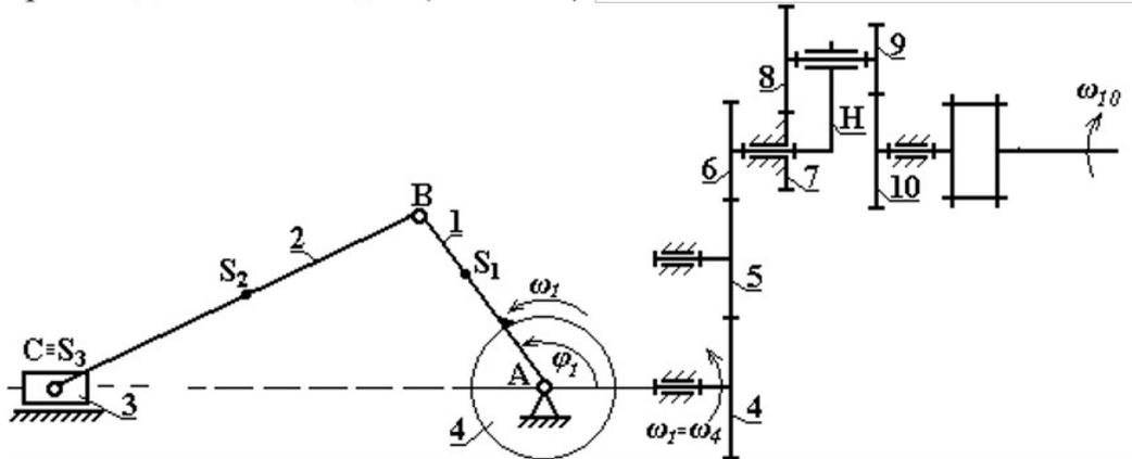
1. Для планетарной ступени зубчатого механизма определить степень подвижности.
