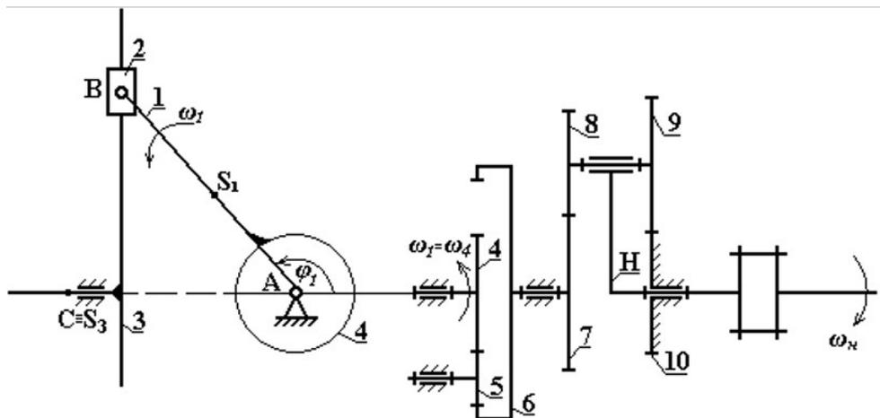
1. Для планетарной ступени зубчатого механизма определить степень подвижности.
