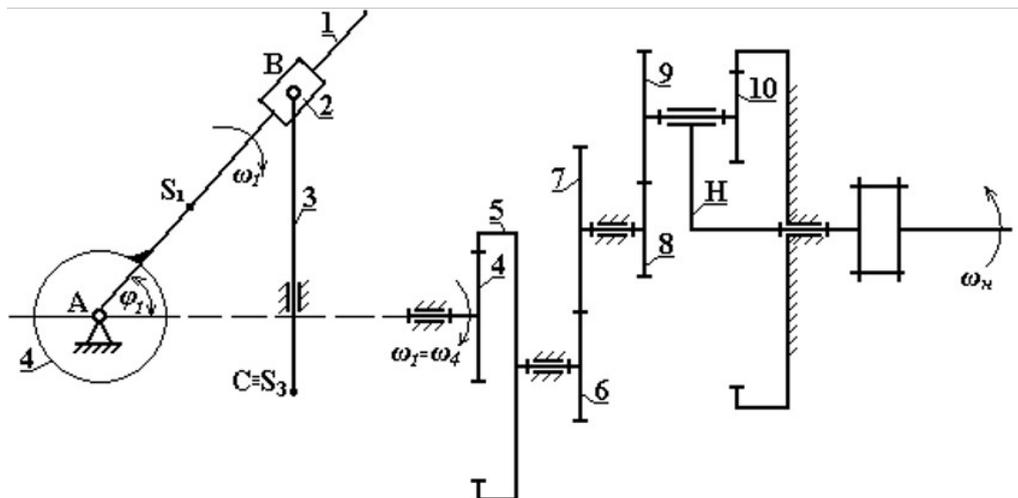
1. Для планетарной ступени зубчатого механизма определить степень подвижности.
