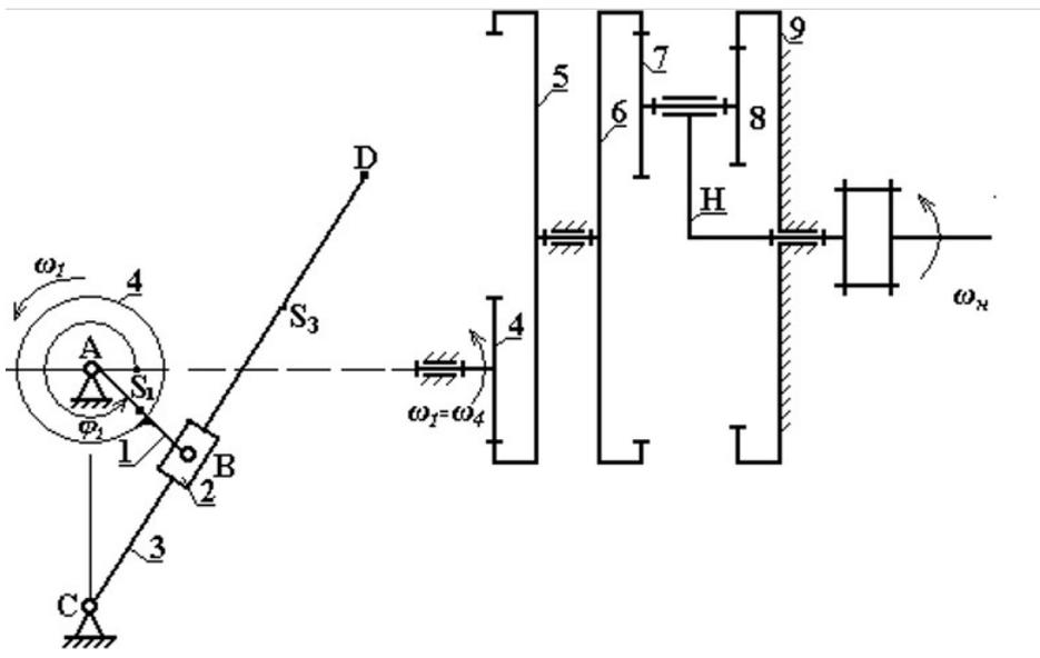
1. Для планетарной ступени зубчатого механизма определить степень подвижности.
